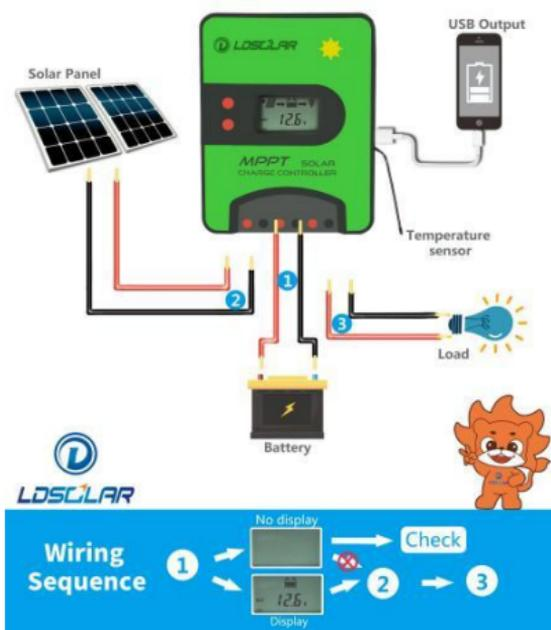
Figura 2-3 Esquema de conexiones
